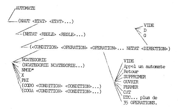
NAUT est le nom de l'automate, il s'agit d'un identificateur choisi par l'usager. NETAT est le nom d'un état; les NETAT sont composés de la lettre S suivie d'un chiffre; exemples: Sl S2 S3... S45. Le premier état d'un automate doit obligatoirement se nommer Sl; pour les autres le choix du numéro est laissé à la discrétion de l'usager. Quoiqu'il soit recommandé de le faire, les états ne doivent pas nécessairement être en ordre numérique croissant.
